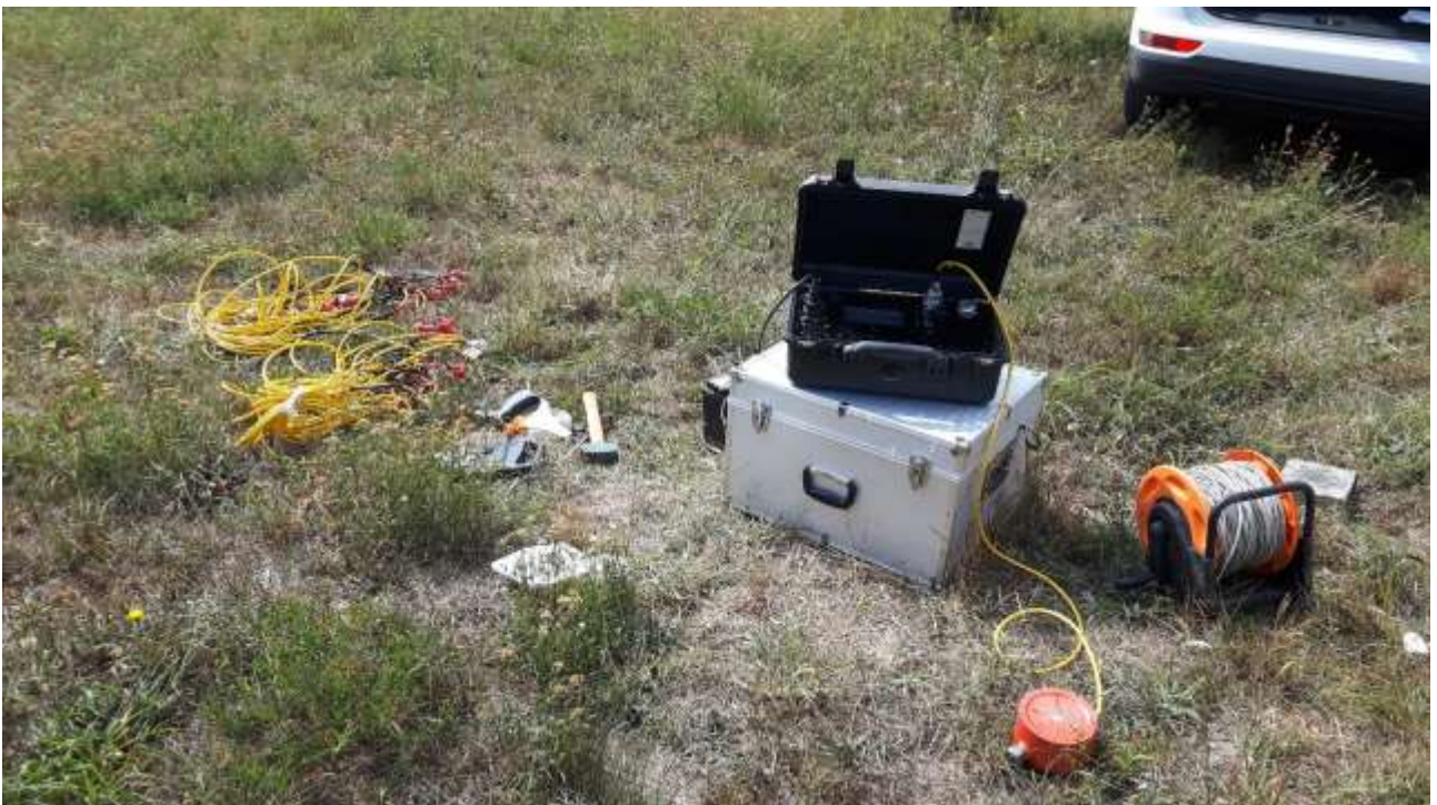
Figura 10. Sito prova HVSR n.2, dettaglio sulla strumentazione utilizzata.
